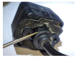
8. СНИМИТЕ ШЛАНГ С ШТАТНОГО СОЕДИНИТЕЛЯ И УСТАНОВИТЕ ТРОЙНИК ИЗ КОМПЛЕКТА.
